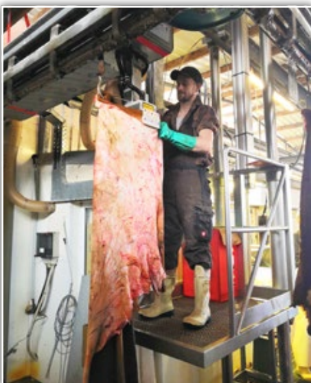
Mit einem Laser werden die Häute seitlich der Schwanzwurzel markiert; das System wurde gemeinsam mit der Firma SLCR Lasertechnik entwickelt.
